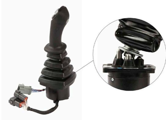
Per ogni elemento di controllo due sensori di posizione mandano segnali separati ai microcontroller, che monitorano la consistenza dell'informazione utilizzando un software appositamente sviluppato da Bosch Rexroth.
